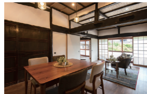
和室2間を仕切る建具を取り除き、一続きの10帖のリビングダイニングが誕生。床を貼り替え、壁は漆喰壁としました。天井はガマ芯仕上げとなっています。
